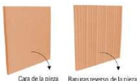
PASO 4: Se recomienda instalar el producto conservando una distancia entre pieza y pieza de entre 0.5 mm a 1 cm.
